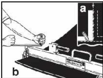
1. Отметьте перпендикулярную линию отреза ленты (a) используя метод центральной линии. Используйте резак Flexco 900-ой серии или 300-ой серии для получения прямой линии отреза (b)
