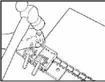
6. Следующими установите соединители на краях ленты. Для этого поднимите рычаги, переставьте инструмент, повторите шаг 5. Используйте молоток весом 0,5 кг.
