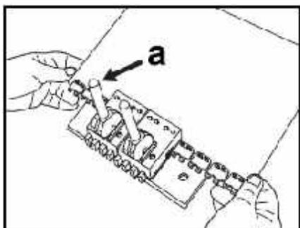
4. Установите полоску соединителей внутри устройства для установки. Рычаг (рычаги) должны быть в верхнем, свободном положении (a).
