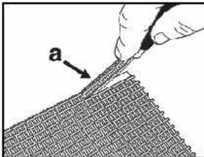
2. Выберите правильный размер соединения. Ознакомьтесь с инструкцией по использованию установочного инструмента. Снимите часть обкладки конвейерной ленты, используя соответствующий инструмент Flexco (a).
