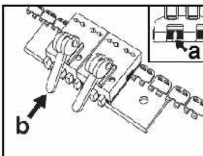
5. Край ленты должен находиться вплотную к выступу в соединителях (a). Опустите рычаги устройства для установки соединителей (b).
