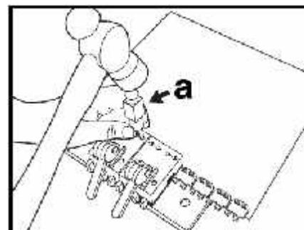
6. Используйте молоток весом 0,5 кг. С его помощью, ударами по пробойнику (a), начните монтаж с центральной пластины соединителей. Не применяйте излишних усилий.
